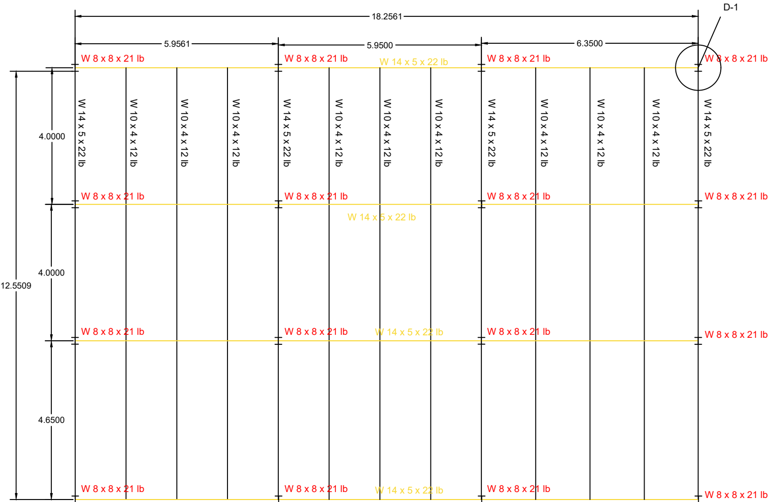
Planta Estructural de techo
